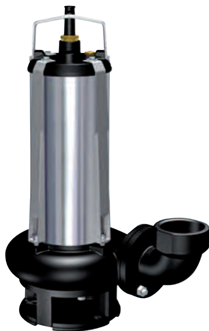
S 500 et 800/50 : roue VORTEX S 900 et 1000/50 : roue bi-canal Ø refoulement 2" 1/2 (sauf SÉMISOM 500 2")
