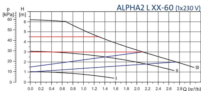
L'ALPHA2 est livré pré-réglé usine en position intermédiaire : Pression **proportionnelle** (90 % des installations de chauffage domestique sont concernées)
