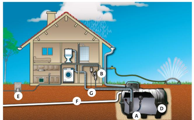
A : SBA AW - B : Kit d'appoint eau potable avec flotteur de niveau - D : Réserve eau de pluie - E : Réseau eau potable - F : Réseau évacuation eau pluviale - G : Eau de pluie stockée
