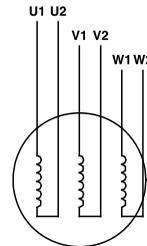
**Fig. 14** Connexion/marquage de câble non identifié - enroulements moteur pour démarrage étoile-triangle
