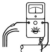
Déconnecter le câble immergé du disjoncteur. Mesurer la résistance d'isolement de chaque phase vers la terre (masse). S'assurer que la mise à la terre est effectuée correctement.
