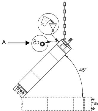
**Fig. 5** Position du moteur pendant le remplissage - MMS
