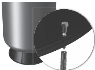
Fig. 4 Installation du réservoir doté d'un châssis en plastique
