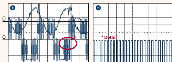
Fig. 4.5.4 : a) Courant moteur (illustration du dessus) et tension moteur avec modulation de la largeur d'impulsion. b) Section de la tension moteur
