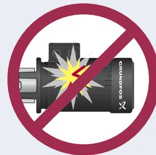
Fig. 1.4.5 : Pour les moteurs à sécurité augmentée EExe, aucune étincelle n'est susceptible de se produire. La classification des températures couvre à la fois les surfaces intérieures et extérieures.
