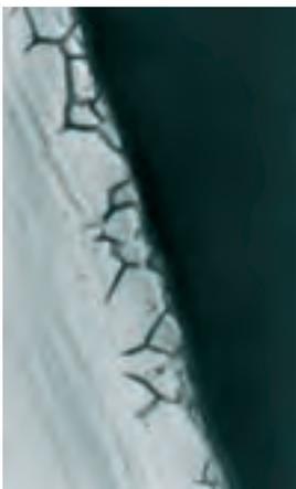
Corrosion intergranulaire de l'acier inoxydable
