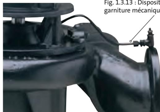
Fig. 1.3.13 : Dispositif de rinçage d'une garniture mécanique simple
