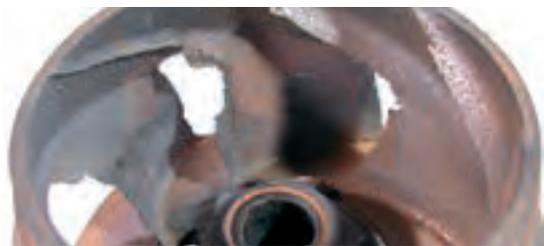
Corrosion-érosion d'une roue en fonte
