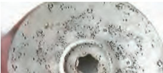
Corrosion par piqûres de l'EN 1.4401 (AISI 316)
