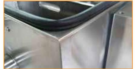
Le nouveau joint du couvercle assure une étanchéité encore plus performante.
