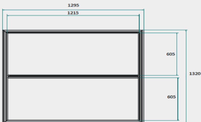
Exemple de configuration pour structures avec caissons filtres motorisés « Modulac »
