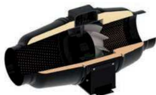
Isolation intérieure 50 mm et turbine conique à pales profilées, sauf taille 315 S et 400
