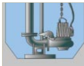
La configuration de cuve standard depuis 30 ans. Le fond plat crée des zones de stagnation où les solides s'accumulent.
