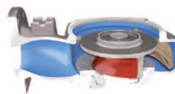
Etape 2 : la rainure de dégagement et le guide pin du fond de volute évacuent les solides, tels que les chiffons.
