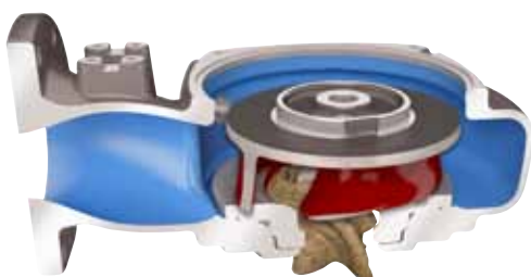
Etape 1. Les aubes de la roue N avec ses bords d'attaque inclinés vers l'arrière guident les solides du centre vers la périphérie de la roue.
