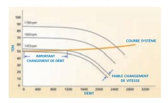
C'est pourquoi, au lieu de changer la vitesse, Flygt PumpSmart fait varier le débit de la pompe en modifiant le couple. Cela transforme une courbe de performances relativement plate en une courbe à forte pente, qui est facile à contrôler.
