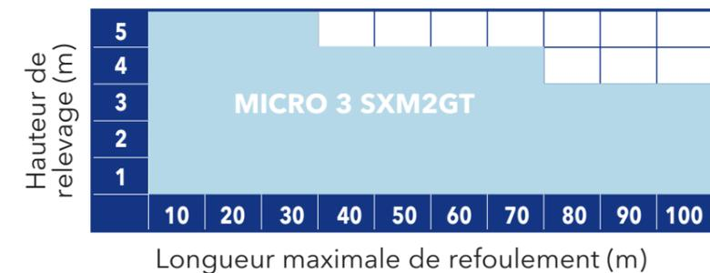
En croisant la longueur de refoulement avec la hauteur de relevage, sélectionnez la MICRO 3 correspondant à votre installation. Votre application est en dehors des critères ci-dessous, n'hésitez pas à nous contacter pour la sélection du produit Flygt approprié.
