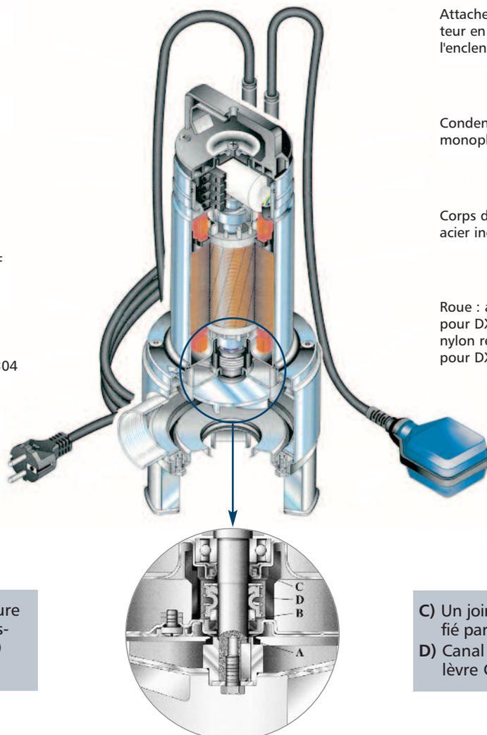
Attache permettant le réglage du détecteur en fonction du niveau choisi pour l'enclenchement de la pompe
