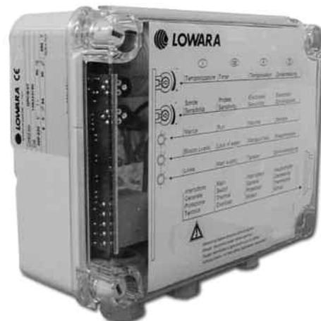
Pour une bonne association coffret électrique-électropompe, vérifier que l'intensité absorbée du moteur en ampère est compatible avec les valeurs de courant nominal indiquées au tableau.
