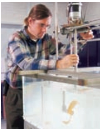
Le profil des pales « banane » est vérifié méticuleusement sur maquette à notre laboratoire central d'agitation.
