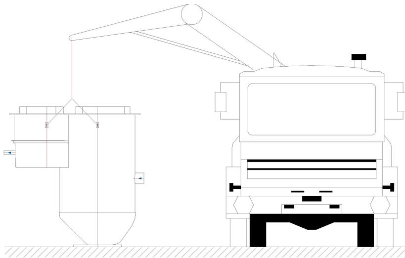
Si la station de pompage doit être stockée un certain temps avant son installation, il convient de la mettre en position horizontale ou de la caler de manière appropriée en position verticale.
