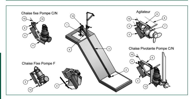
Systèmes de guidage inclinés pour pompes et agitateurs
