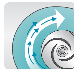
La roue Flygt laisse les particules s'écouler avec la volute.
