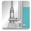
T: Fosse sèche, montage vertical. Solution résistante aux inondations et facilitant la maintenance et l'entretien (5500 uniquement).
