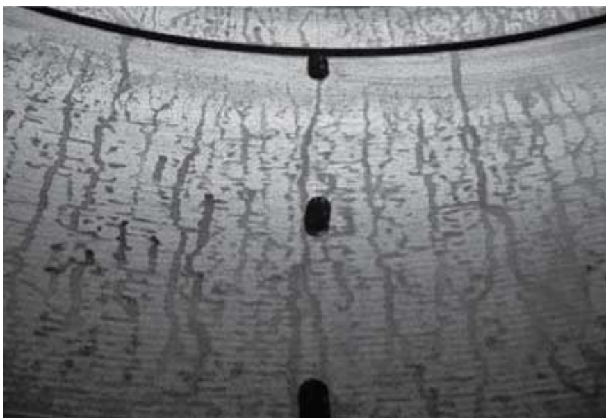
Рис. 43: Отверстие овальной формы, полученное в результате сверления двух примыкающих отверстий
