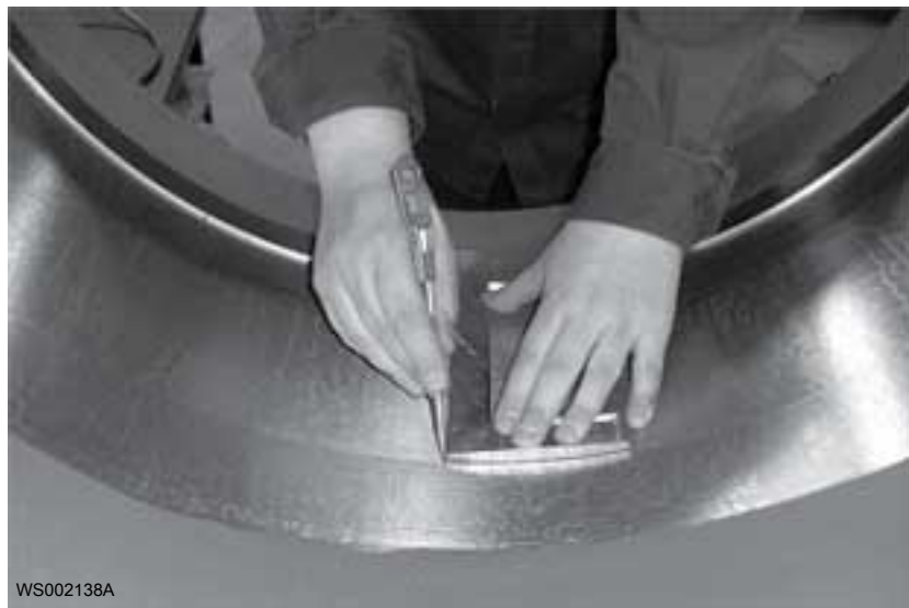
Рис. 43: Проведении прямой линии для сверления
