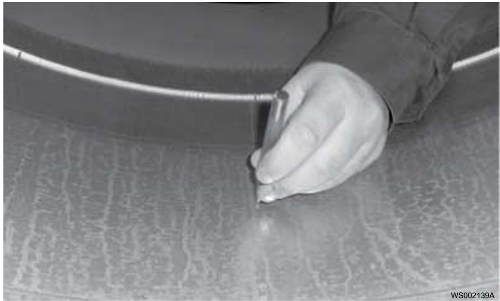
Рис. 44: Отметка мест для отверстий
