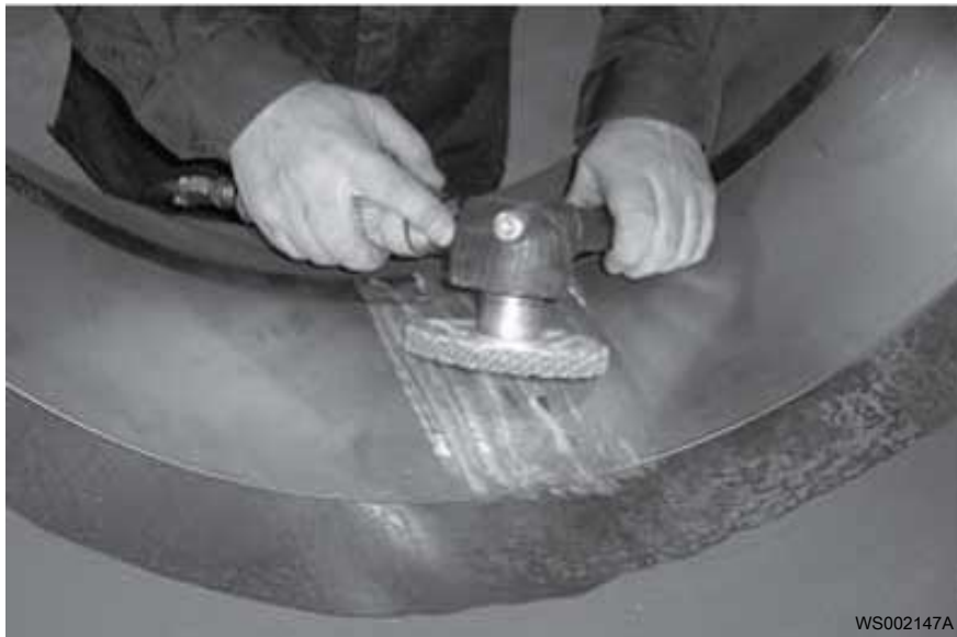
Рис. 53: Полировка сварного шва
