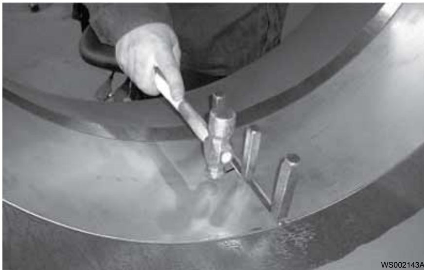
Рис. 45: Закрепление компенсационного кольца
