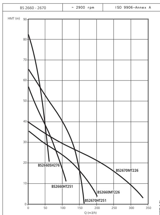
Les performances déclarées sont valables pour des liquides ayant une densité  $\rho = 1.0 \text{ kg/dm}^3$  et une viscosité cinématique  $\nu = 1 \text{ mm}^2/\text{s}$ .
