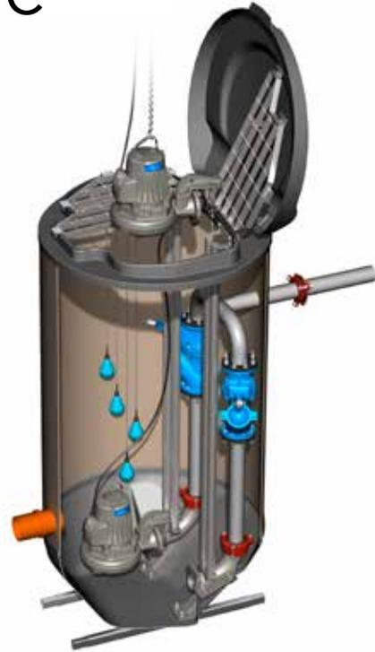
Dans une station à deux pompes, on utilise en général quatre régulateurs de niveau. Le premier est placé au niveau de l'arrêt de pompage, le deuxième et le troisième sont placés au niveau de démarrage de chaque pompe et le quatrième régulateur sert à déclencher une alarme de niveau haut.
