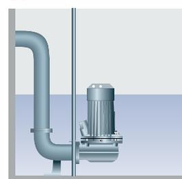
Version immergée fixe : avec pied d'assise, double barre de guidage et chaîne.
