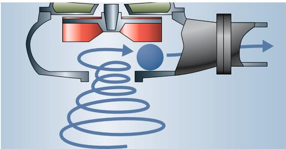
Fiabilité élevée, usure réduite : le puissant effet de pompage de la roue vortex favorise le passage de corps solides volumineux à travers le corps de pompe sans le colmater.
