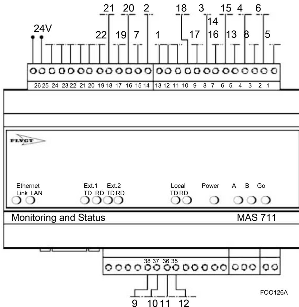
Рис. 20: Подключения к основному блоку MAS 711.
