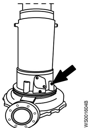
Рис. 30: Вход для линии подачи охлаждающей жидкости
