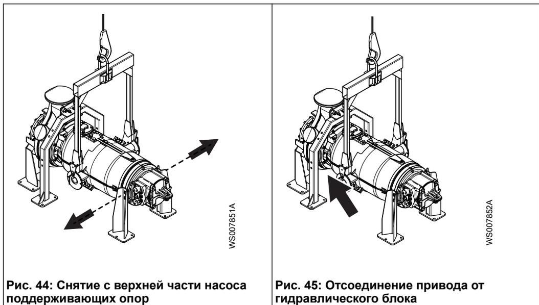
Рис. 44: Снятие с верхней части насоса поддерживающих опор
