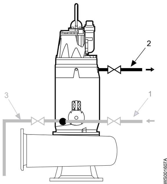
**Рис. 28: Подключение возвратной линии охлаждающей жидкости**
