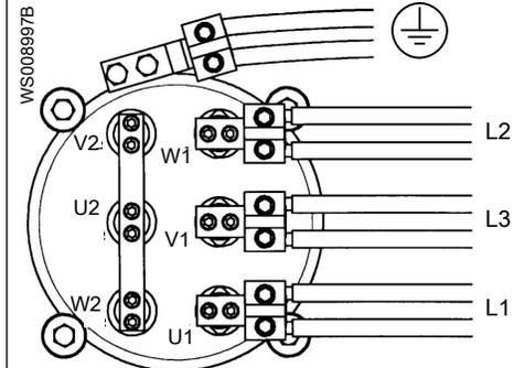
**Соединение звездой/треугольником, 2 кабеля**
