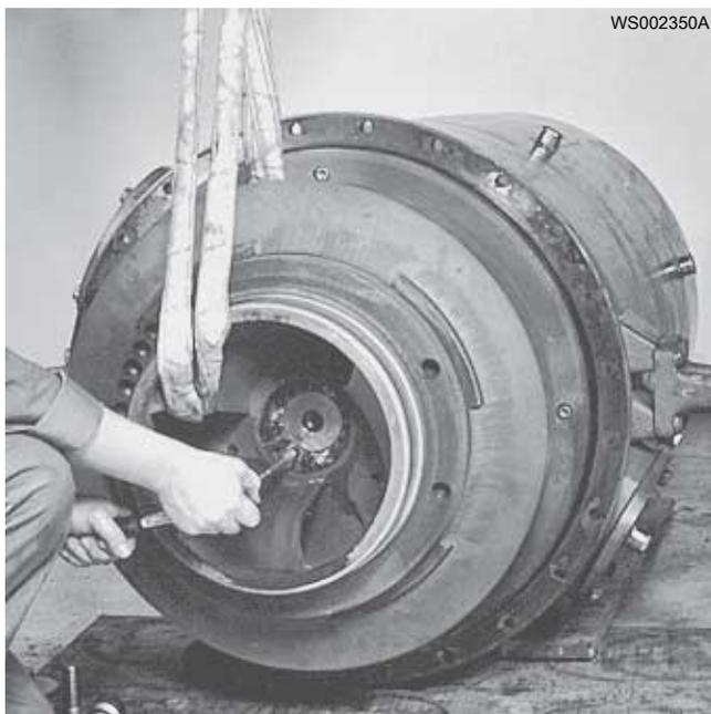
3. Снимите стопорное устройство.
