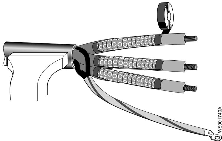
8. Закрепите соединительный башмак и проушину на проводах.
