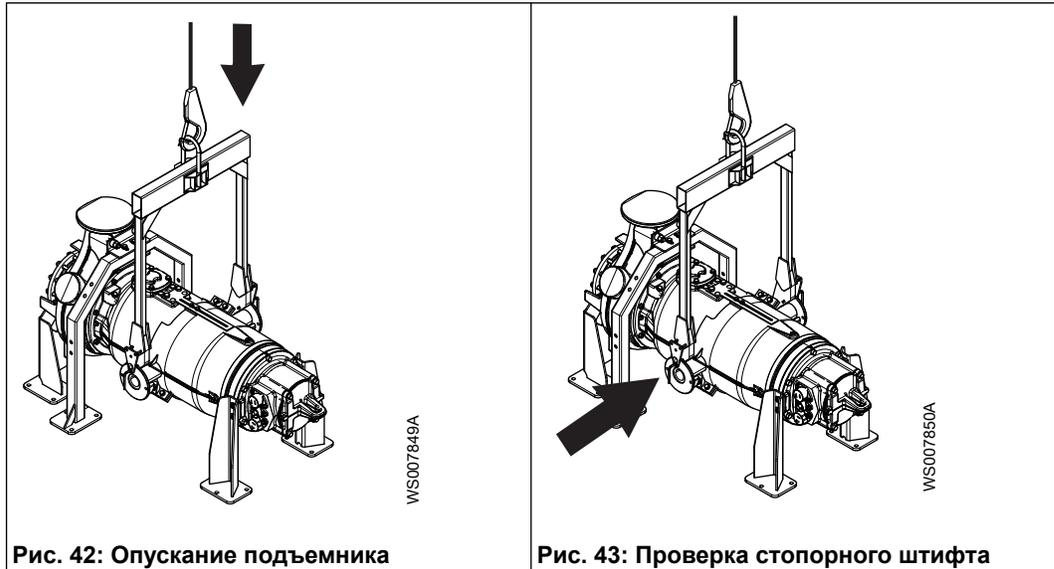
Рис. 42: Опускание подъемника
