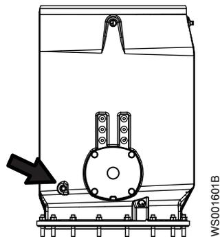
Рис. 32: Вход для линии подачи охлаждающей жидкости
