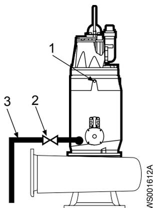
1. Вентиляционный винт
