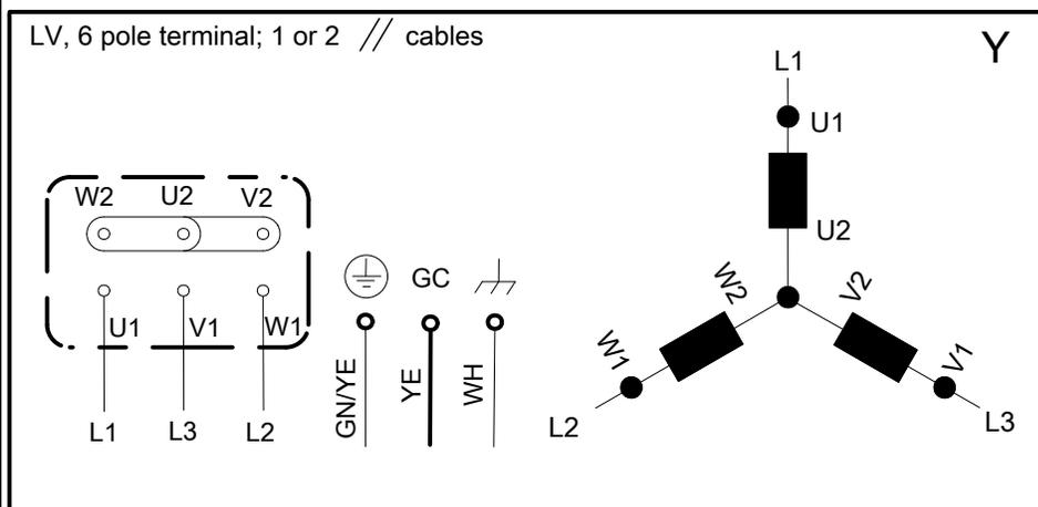
**Соединение звездой, 1 или 2 кабеля**
