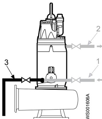
Рис. 29: Соединительная арматура для слива охлаждающей жидкости
