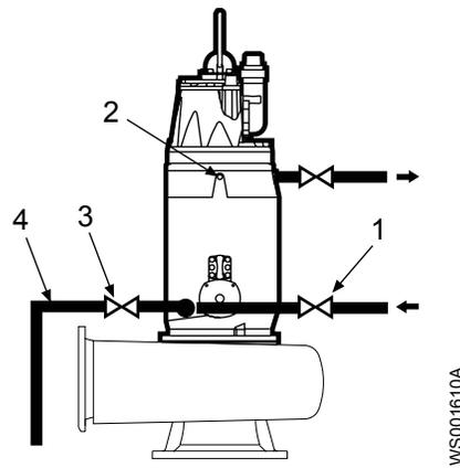
1. Впускное отверстие для охлаждающей жидкости
