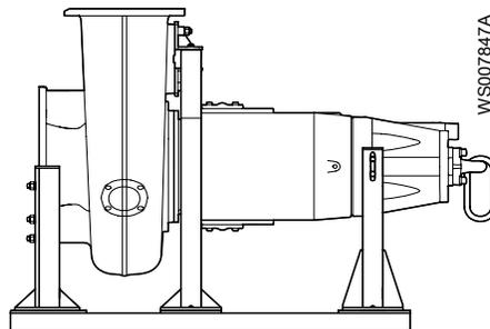
При вариантах установки типа Z с использованием встроенной системы охлаждения требуется определенное расположение. Привод должен быть ориентирован так, чтобы система удаления воздуха и датчик течи в корпусе статора функционировали надлежащим образом. Крышка смотрового люка рубашки охлаждения, имеющая маркировку SENSORS (ДАТЧИКИ), должна быть направлена вниз.
