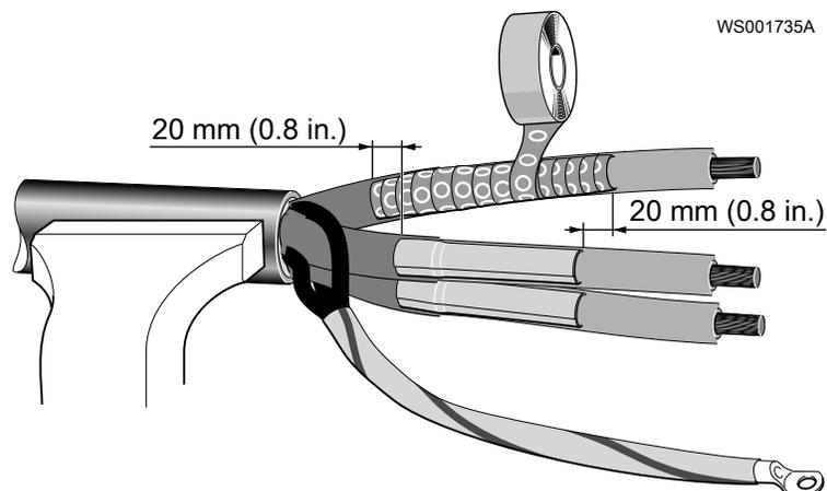
7. Закрепите концы самоклеющейся ленты изоляционной лентой.
