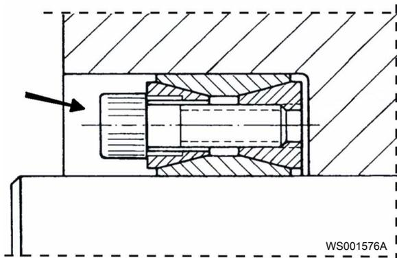
6. Установите на место уплотнительную шайбу рабочего колеса и затяните винт рабочего колеса.
