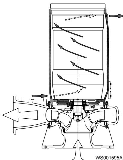
**Рис. 8:** Пример для пояснения принципа внешнего охлаждения.
