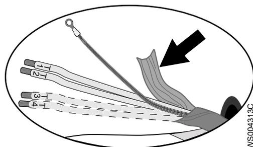
**Рис. 24: Медная фольга на проводах цепей контроля.**
