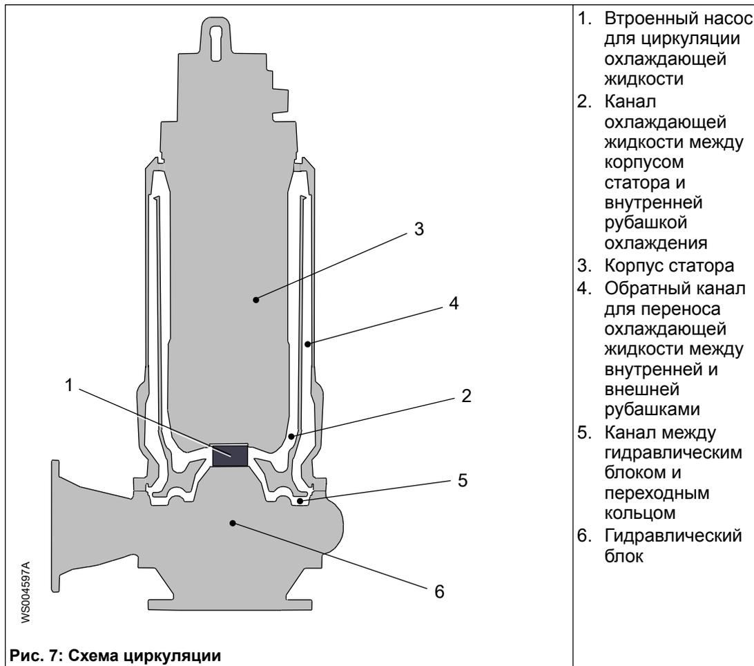
1. Встроенный насос для циркуляции охлаждающей жидкости
