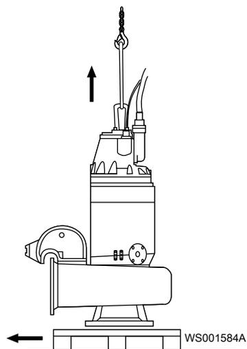
8. Установите агрегат вертикально на жесткую горизонтальную поверхность и убедитесь в том, что он не может опрокинуться.
