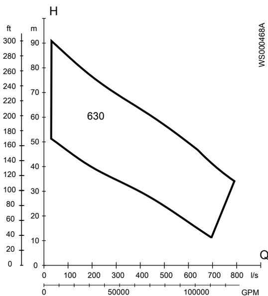
Рис. 25: С3312, 60 Hz, среднее напряжение
