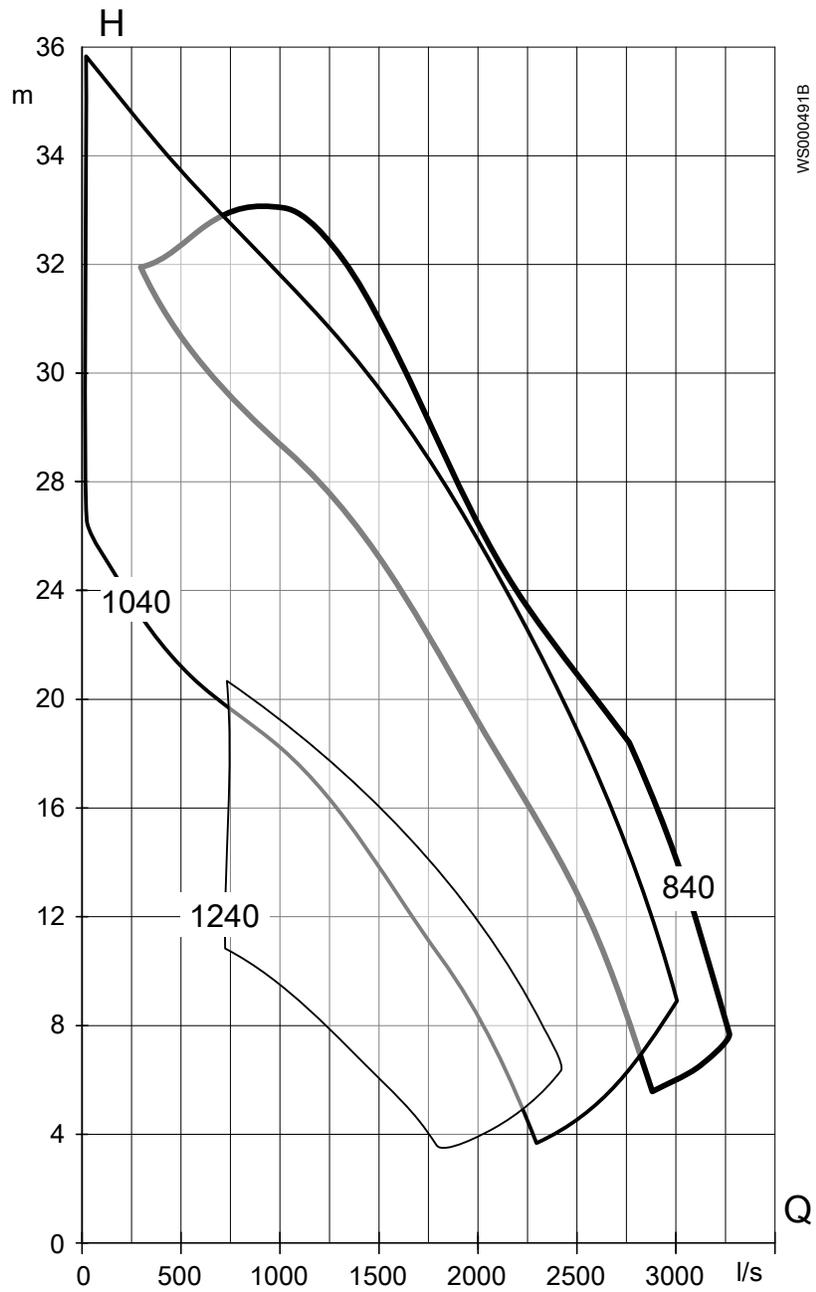
Рис. 19: С3800, 50 Hz, среднее напряжение
