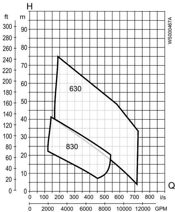
Рис. 24: С3312, 60 Hz, низкое напряжение
