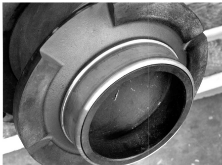
Рис. 9: Износное кольцо рабочего колеса
