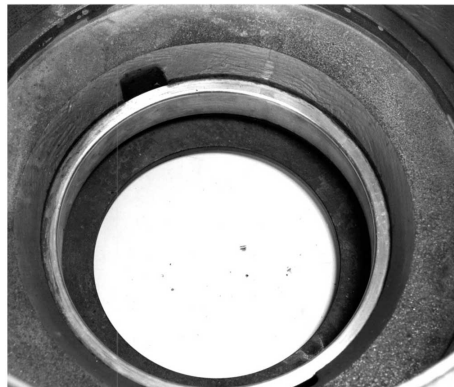
Рис. 8: Изношенное кольцо в корпусе насоса
