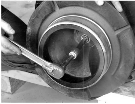
Рис. 13: Затяните винт рабочего колеса.
