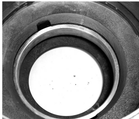
Рис. 8: Изношенное кольцо в корпусе насоса
