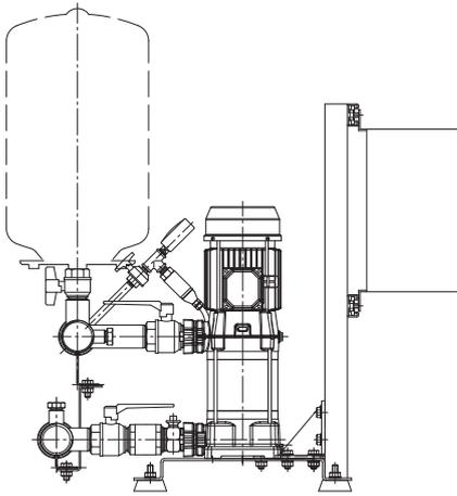
Groupes commandés par inverter avec deux pompes multicellulaires verticales.
