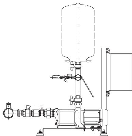
Groupes commandés par inverter avec deux pompes multicellulaires horizontales.
