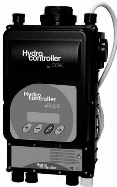
Dispositif électronique professionnel à passage d'eau destiné au contrôle d'électropompes, basé sur une technologie à inverter. Contrôle le démarrage et l'arrêt d'une électropompe et régule le débit à pression constante en fonction de la demande en eau de l'installation. Adapté à la réalisation de groupes de surpression jusqu'à 8 pompes. Il garantit un confort considérable pour l'utilisateur final, des économies d'énergie significatives et une plus longue durée de vie de l'installation.
