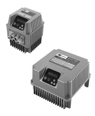
Dispositif électronique avec commande par signal externe destiné au contrôle d'électropompes, basé sur une technologie à inverter. Vérifie le démarrage et l'arrêt de l'électropompe et module les tours du moteur en fonction du prélèvement d'eau du système, afin d'optimiser les exigences du système. Garantit un confort considérable pour l'utilisateur final, des économies d'énergie significatives et une plus longue durée de vie de l'installation.
