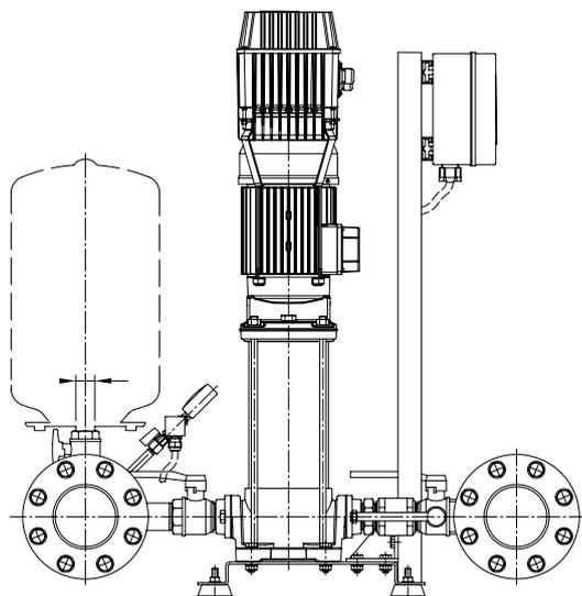
Groupes avec trois pompes multicellulaires verticales avec hydrauliques en acier inoxydable.
