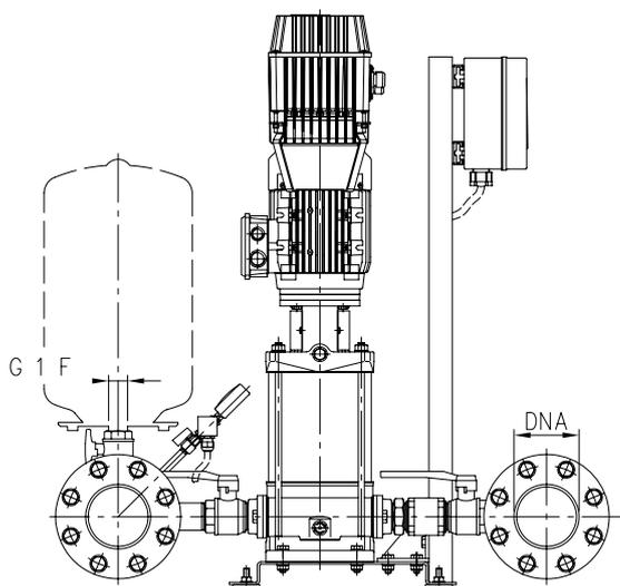
Groupes avec trois pompes multicellulaires verticales avec hydrauliques en acier inoxydable.
