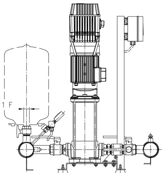
Groupes avec deux pompes multicellulaires verticales avec hydrauliques en acier inoxydable.
