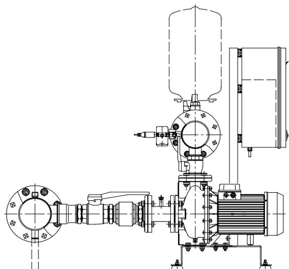
Groupes avec deux pompes centrifuges horizontales avec hydrauliques en acier inoxydable.
