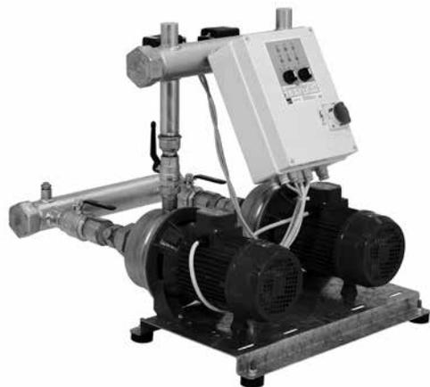
Groupes avec deux pompes à deux rotors horizontales avec hydrauliques en acier inoxydable.
