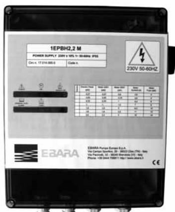
Coffrets de protection et de commandes pour une électropompe submergée ou de surface à démarrage direct. Le coffret est prévu pour commander manuellement et automatiquement une électropompe. Au cours du fonctionnement automatique, la commande de l'électropompe est donnée par le pressostat, par le flotteur ou par les autorisations provenant des électrosondes ou des flotteurs.
