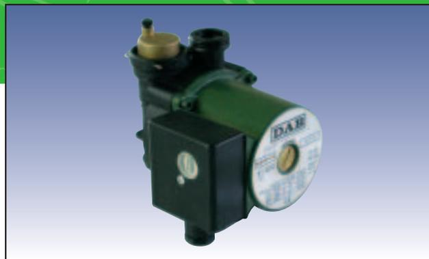
Pompe pour la circulation d'eau chaude dans les installations domestiques centralisées de chauffage et de climatisation de type fermé et sous pression ou à vase ouvert. Indiqué également pour les installations à énergie solaire. Cette pompe est la combinaison entre un circulateur traditionnel et un dispositif dégazeur.
