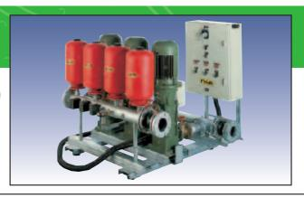
groupes à 2-3 électropompes. Sélecteurs pour fonctionnement électropompes en Automatique (au moyen de pressostats situés sur le collecteur de refoulement) ou en Manuel. Bornier de connexion d'un éventuel pressostat d'arrêt pour pression minimum, interrupteur à flotteur pour arrêt marche à sec, démarrage pompes à distance.
