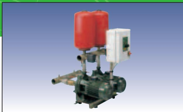
Groupe de relevage de l'eau avec 2 électropompes centrifuges à deux turbines type K, avec base, collecteur sur l'aspiration et sur le refoulement, 2 réservoirs à vessie et coffret électrique muni de:
