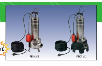
Pompe centrifuge submersible en acier inoxydable avec roue à vortex liquide, réalisé en acier moulé de précision (technopolymère pour la version VX), adaptée au relevage d'eaux vannes et d'eaux usées en général, contenant des corps solides de dimensions maximums jusqu'à 50 mm.
