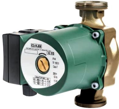
Pompe pour la circulation d'eau chaude dans les installations domestiques à eau chaude de type circuit fermé sous pression ou circuit ouvert. Également adaptée aux installations d'énergie solaire. Corps unique constitué d'une unité hydraulique en bronze. Carter du moteur en aluminium moulé sous pression. Roue en technopolymère. Axe moteur en aluminium avec roulements en graphite lubrifiés par le liquide pompé.
