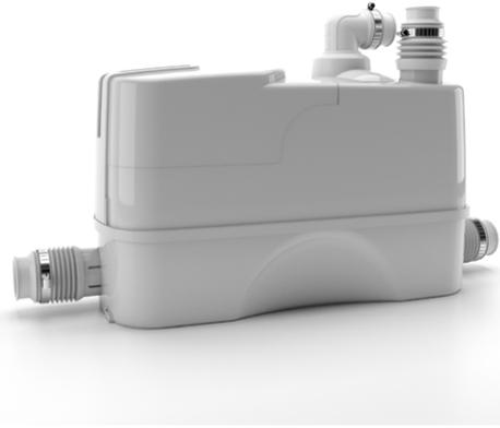
Indispensable dans les cas où les eaux usées provenant des lavabos, des douches, des machines à laver et des lave-vaisselle ne peuvent pas être évacuées par gravité. Il s'agit d'une station de relevage qui collecte et pompe les eaux usées à travers un tuyau de petite taille vers le système d'égout public le plus proche.
