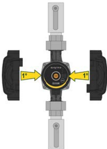
Obrázek 6: Izolace tělesa čerpadla
