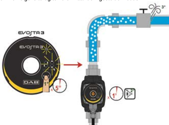
Afbeelding 8: Automatische ontluchting van de pomp
