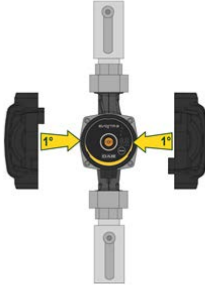
Resim 6: Pompa gövdesinin yalıtımı
