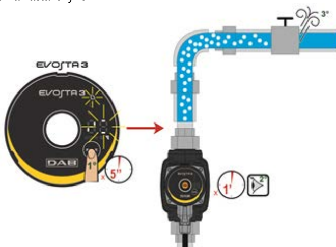
Obrázek 8: Automatické odvzdušnění čerpadla
