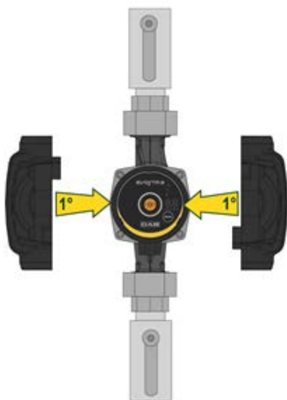
6 pav.: Siurblio korpuso izoliavimas
