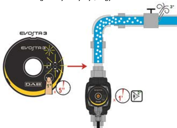
8. ábra: A pumpa automatikus légmentesítése
