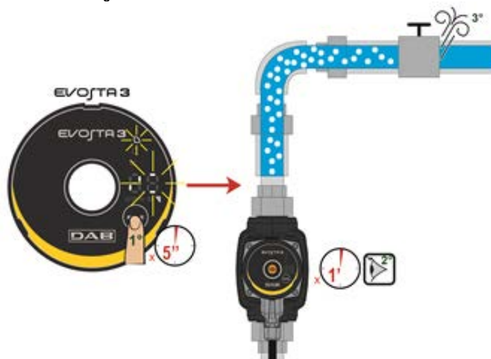
Fig 8: Automatisk avluftning av pumpen
