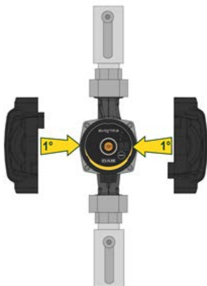
Afbeelding 6: Isolatie van het pomphuis
