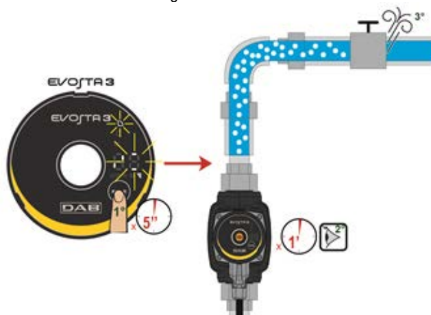
Image 8: Purge automatique de la pompe
