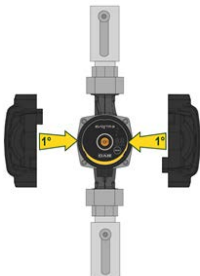
Fig. 6: Isolering af pumpehus
