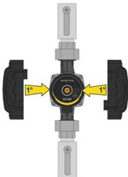
Figura 6: Isolamento do corpo da bomba
