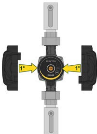
Εικόνα 6: Μόνωση του σώματος της αντλίας
