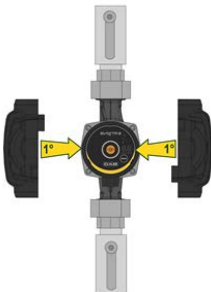
6. ábra: A pumpatest elszigetelése
