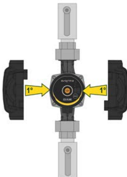
Rysunek 6: Izolacja korpusu pompy
