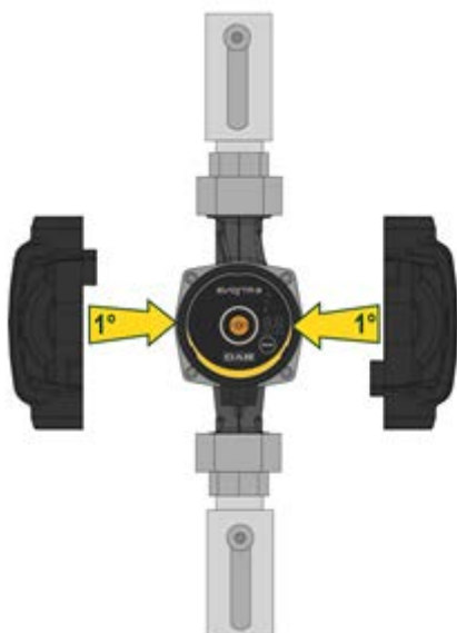
Kuva 6: Pumpun rungon eristys
