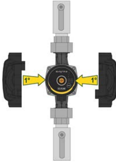
الشكل 6: عزل جسم المضخة
