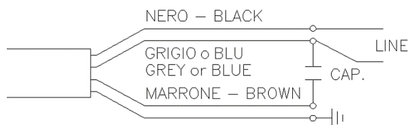
Figura 1: Schema di collegamento versione monofase Figure 1: Single-phase wiring diagram Figure 1: Schéma de connexion version monophasée Figura 1: Verbindungsschaltplan der einphasigen Version رسم 1: رسم مخطط توصيل كهربائي نموذج وحيد الدارة
