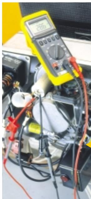
**Mesure de la valeur d'une capacité de démarrage d'un moteur monophasé.**
